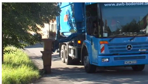
Abb. 1-3: Müllsammelfahrzeug bei der Tonnenentleerung. 9
